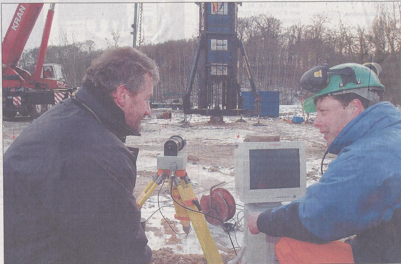
Ingenieur Axel Schöpp (l.) und Martijn van Delft überwachten gestern am Monitor den Verlauf der Belastungsprüfung für die Pfahlgründungen des künftigen Altenheims in Zippendorf.
